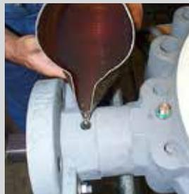
Válvulas de mariposa revestidas completamente para aplicaciones en alta mar
